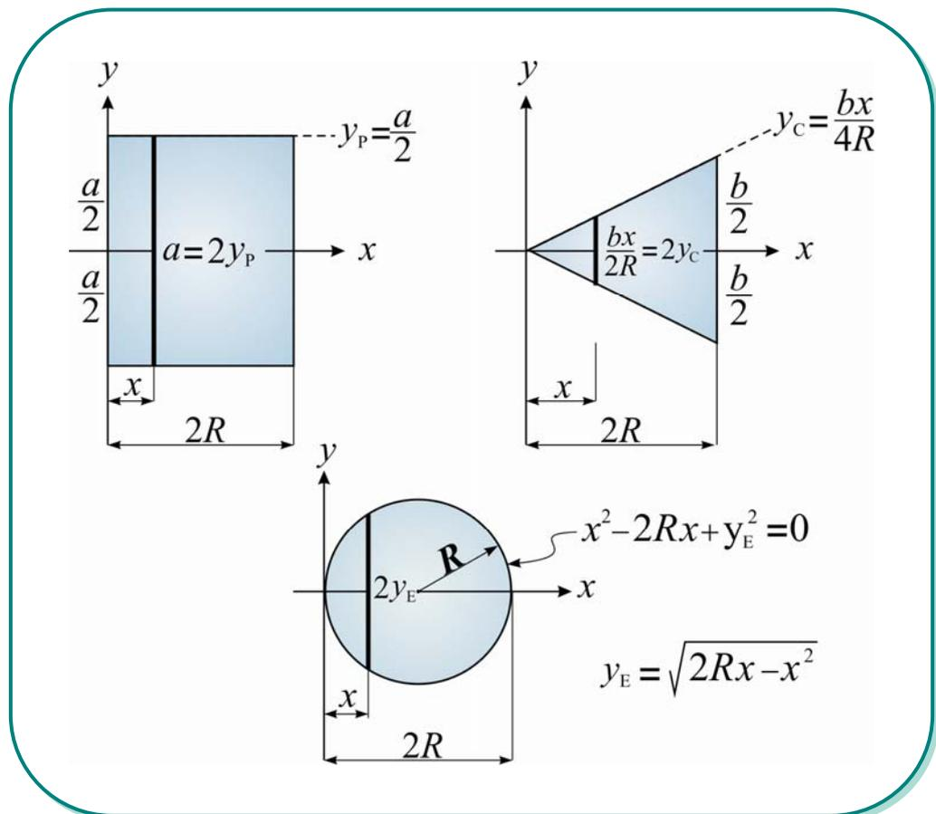
Se hacen rotar las tres figuras alrededor del eje  $x$  generando respectivamente un prisma circular, un cono y una esfera.
